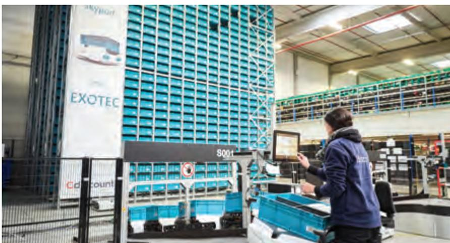
← Cdiscount s'est associé à la start-up Exotec pour développer un système unique de préparation de commandes robotisée. Les Skypod®, des robots logistiques 3D, ont investi l'entrepôt de Cestas, près de Bordeaux.
