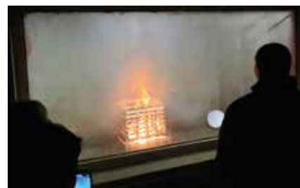
Le feu de palettes déclenché dans un bâtiment a été éteint en moins de 15 secondes par un sprinkler.
